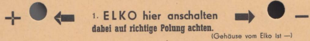
**Gütebeurteilung:** Ein Elko schlägt selten durch, es wird nur der Reststrom höher Zeiger darf bei gutem Elko nur bis zu dem unten angegebenen, nach  $\mu F$  bezifferten Wert gehen.
